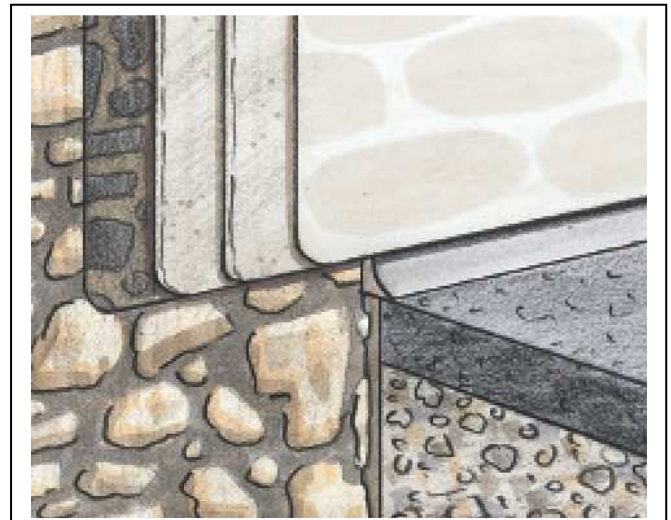
Abb. 21: Hohlkehle aus Zementmörtel
